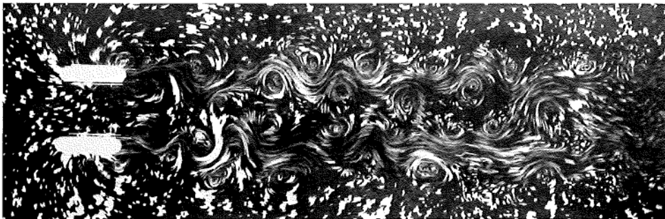
(c) 水温 17.0^{\circ}\text{C} , V=18.11\text{ cm/sec} , Re=1615 , 絞り f8 , シャッター-1/4秒
