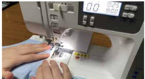
⑱バイアステープの端をミシンで縫う。折り込んだ部分の厚みが原因で針が進まない場合は、押さえ部分に厚紙をはさむ。
