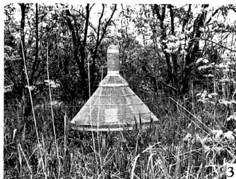
第3図 加藤式ドライアイストラップ (KD)
