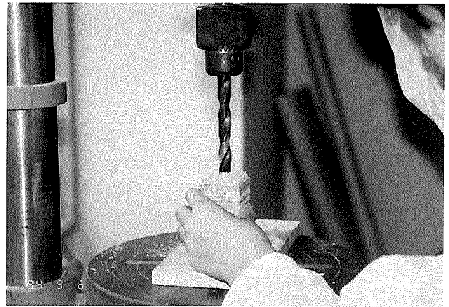
写真6 卓上ボール盤で圧縮した部材に穴をあける
