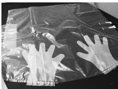
写真2 システムにホットシーラーで取り付けられたグローブバック。
