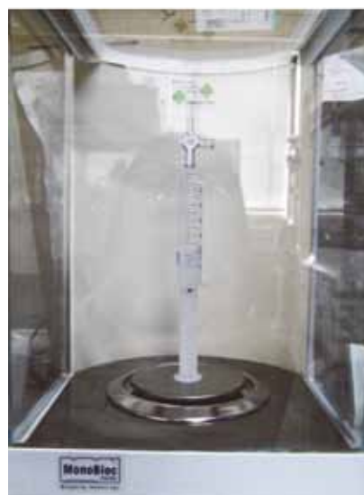
写真2 電子天秤を用いたシリンジの質量測定
