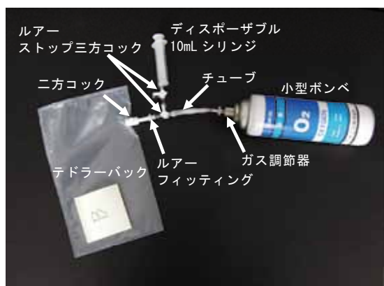
写真6 三方コックとチューブ内からの空気の除去
