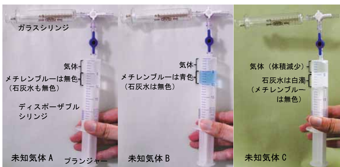
写真9 気体の定性的確認実験。ディスポーザブルシリンジのプランジャーを手で引いてガラス製シリンジ中の気体5 mLをディスポーザブルシリンジに移してから軽く振った後の様子。初めの状態は写真8を参照のこと。
