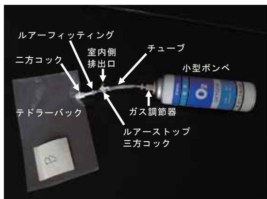
写真5 テドラーバックと小型ポンベの接続
