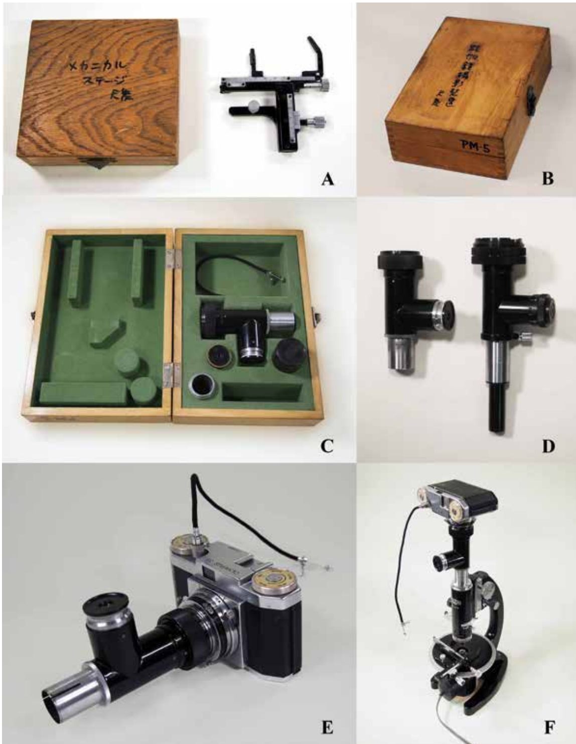
図4. 雄別炭礦尺別硯業所寄贈の研究機器。A：メカニカルステージと収納箱。収納箱の高さ140mm。B～D：OLYMPUS 小型顕微鏡写真装置 PM5。B：収納箱外観。収納箱の長辺250mm。C：収納箱内側と装置の収納状態。D：1960年製 PM-5（右；筆者個人蔵）との比較。35mm コンパクトカメラ（OLYMPUS 35；1955年製；筆者個人蔵）に接続した状態。F：メカニカルステージとともに偏光顕微鏡（OLYMPUS POS型）に装着した状態。
