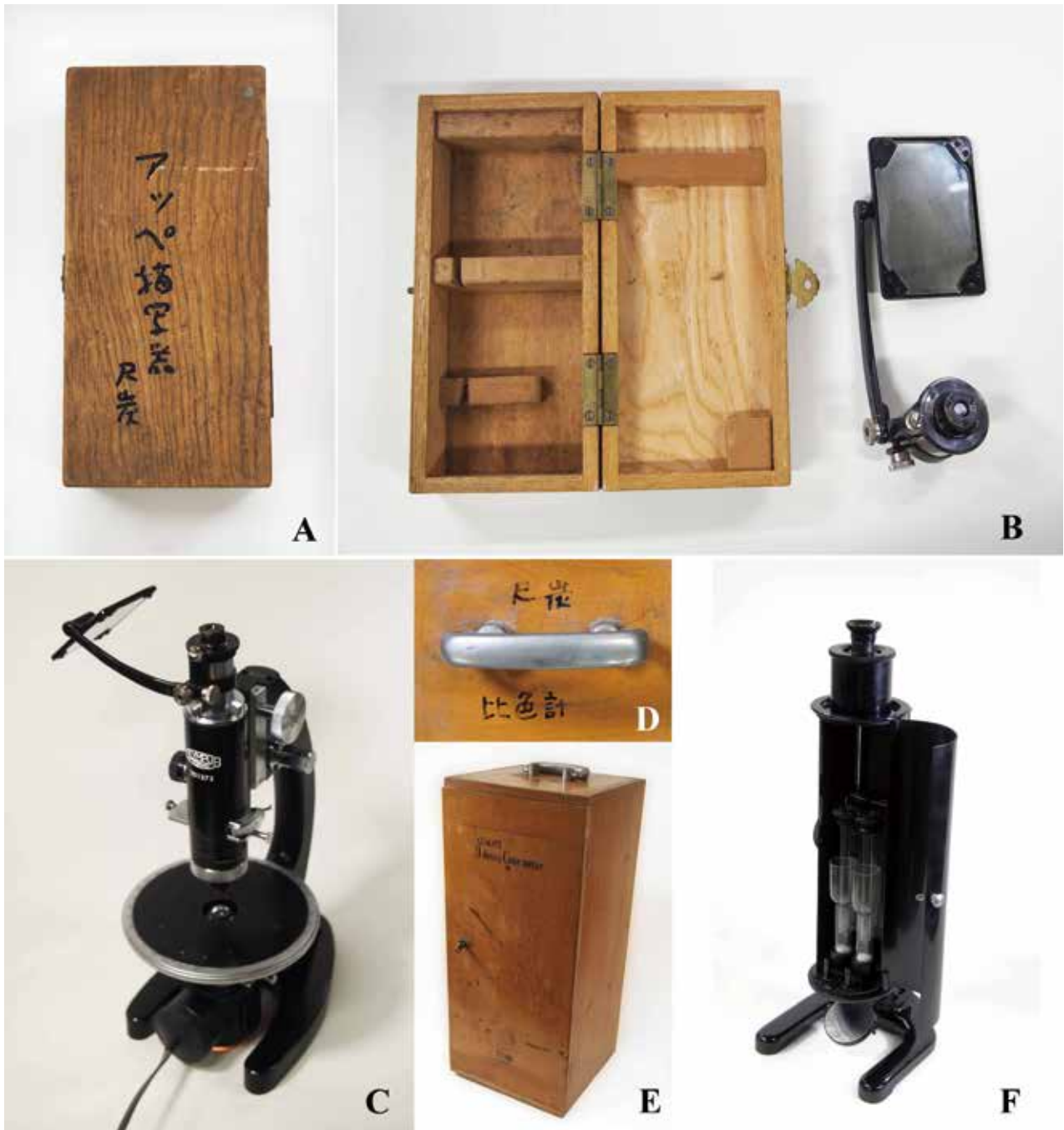
図3. 雄別炭礦株式会社尺別砒業所寄贈の研究機器。A～C：アッペ式描写器。A：収納箱外側。長辺174mm。B：収納箱内側と本体。C：研究室備品の偏光顕微鏡（OLYMPUS POS型，1965年製）に装着した状態。D～F：ATAGO デュボスク式比色計。D：収納箱天板に書かれた「尺炭 比色計」の記述。E：収納箱外観。収納箱の高さ478mm。F：デュボスク式比色計本体。高さ425mm。
