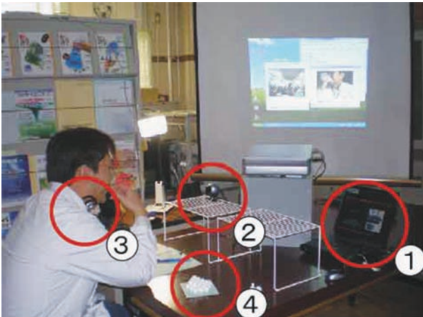
写真2 webカメラを使った双方向遠隔授業を行うための構成。①インターネットに接続したパソコン、②Webカメラ、③マイク付きヘッドホン、④演示実験用の道具。
